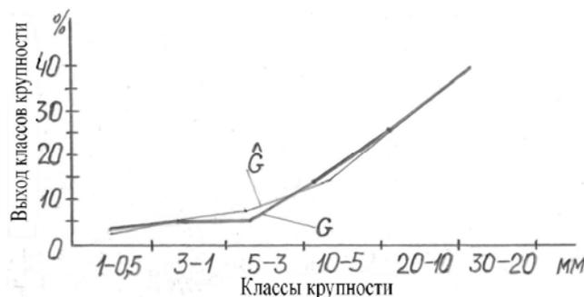
Рисунок 2 – Выход классов крупности при размерах щели 30 мм (щековая дробилка)
